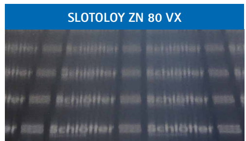
Bild 5: Vergleichende Hullzellenbleche nach 100 Ah/l (Zellstrom 2 A) Elektrolytbelastung, deutlich glänzendere Abscheidung bei Einsatz von SLOTOLOY ZN 80 VX
