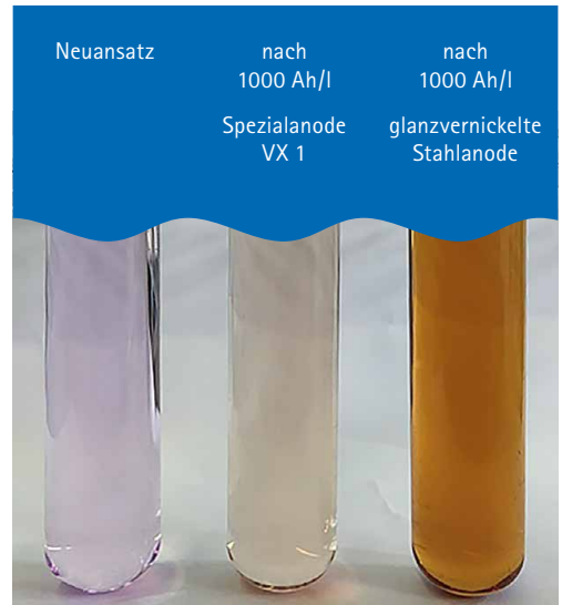
Bild 2: Elektrolytproben sind zur besseren Verdeutlichung 1:10 mit Wasser verdünnt
