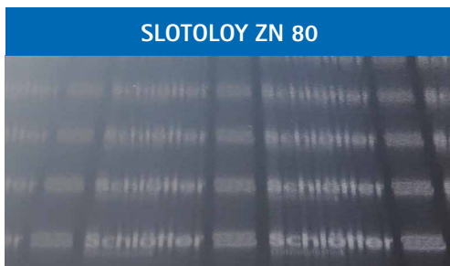
Bild 5: Vergleichende Hullzellenbleche nach 100 Ah/l (Zellstrom 2 A) Elektrolytbelastung, deutlich glänzendere Abscheidung bei Einsatz von SLOTOLOY ZN 80 VX
