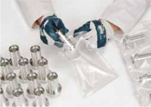
Typisches Laser-Bauteil nach dem Reinbeizen
