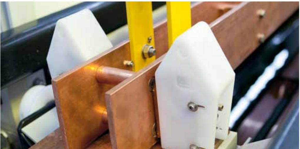
Robuste Ausführung der Anodenschienen für hohe Tragkraft
